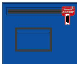
Закройте крышку опечатываемой камеры. Вставьте ПУ в отверстие опечатываемой камеры.
